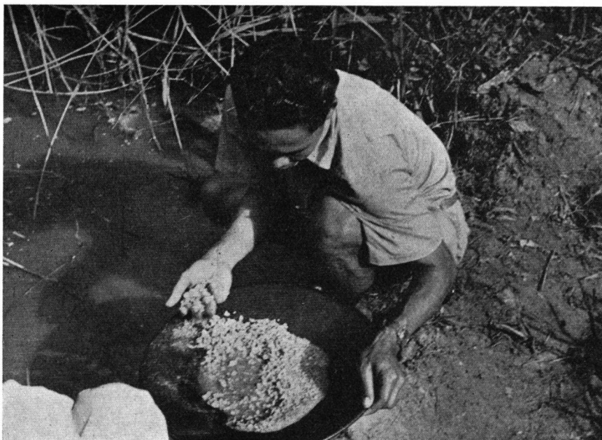
Fig. 1. Het uitwassen van goudhoudend grind met behulp van de batea. Panning out of goldbearing gravel with batea.
