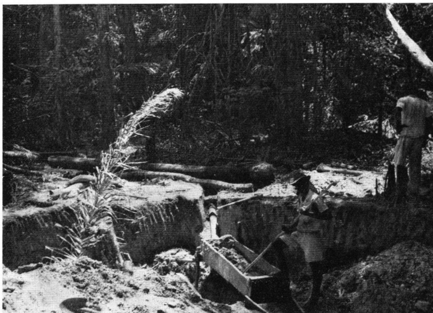
Fig. 2. Exploitation van goudhoudende alluvia met behulp van de long-tom. Exploitation of goldbearing gravel with long-tom.
